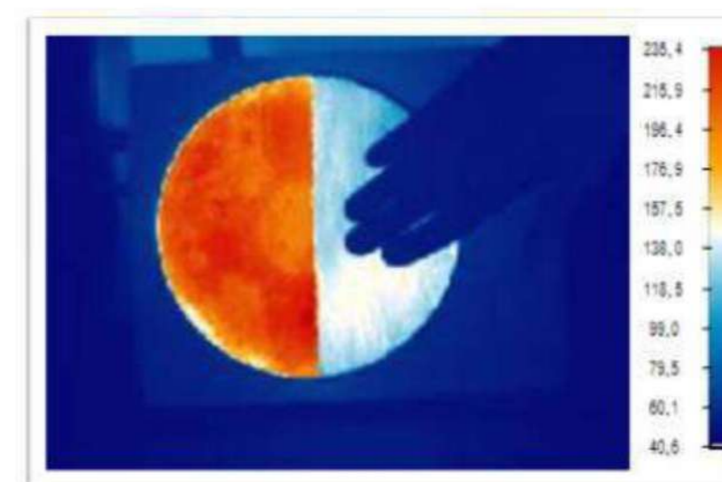
СЪЕМКА ЭЛЕКТРОПЛИТЫ ТЕПЛОВИЗОРОМ, С ПОЛОВИНОЙ, ПОКРЫТОЙ ТЕПЛОИЗОЛЯЦИЕЙ БРОНЯ
